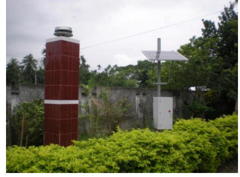
জিপিএসঃ একটি ডিফারেন্স টেকটনিক্স, ভূমিকম্প, প্লেট মুভমেন্ট গবেষণার কাজে ব্যবহৃত জিওডেটিক তথ্য-উপাত্ত সংগ্রহের জন্য স্থায়ী জিপিএস স্টেশন
