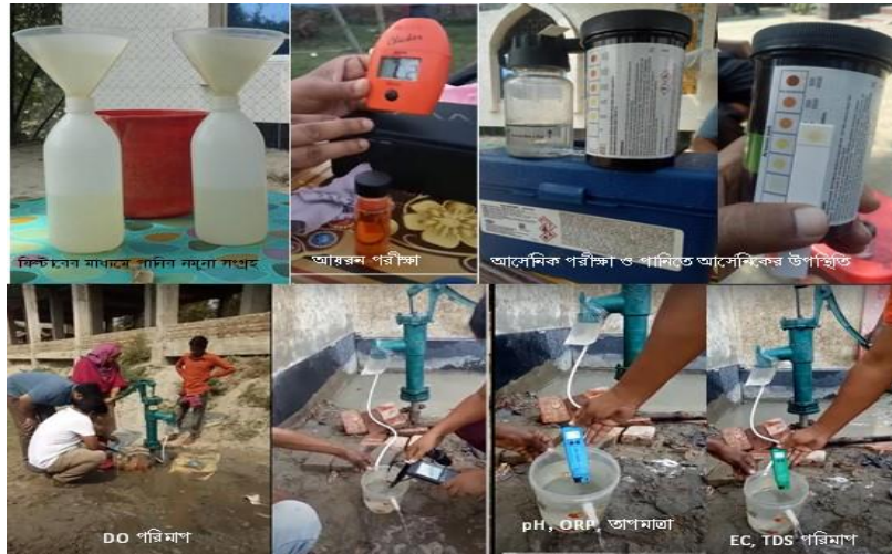
চিত্র-৩. ফিল্টারের মাধ্যমে পানির নমুনা সংগ্রহ, আয়রন পরীক্ষা, পলল সংগ্রহ, আর্সেনিক পরীক্ষাসহ পানির বিভিন্ন ইন-সিটু ভৌত-রাসায়নিক প্যারামিটার
