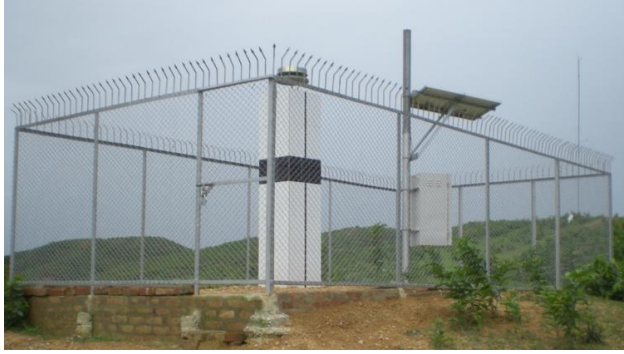
জিপিএসঃ একটি ডিফারেন্স টেকটনিক্স, ভূমিকম্প, প্লেট মুভমেন্ট গবেষণার কাজে ব্যবহৃত জিওডেটিক তথ্য-উপাত্ত সংগ্রহের জন্য স্থায়ী জিপিএস স্টেশন
