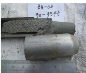
চিত্র-৩. কূপ খননের মাধ্যমে সংগৃহীত ভূ-অভ্যন্তরস্থ পলল
