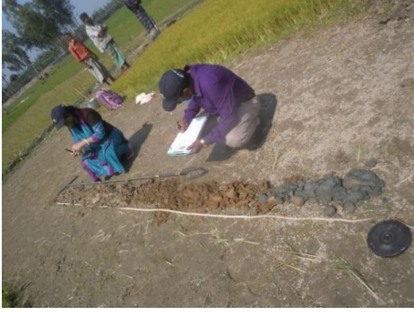
চিত্র-৫. অগার কূপের এর মাধ্যমে সংগৃহীত ভূ-গর্ভস্থ পলল
