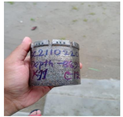
চিত্র-৩. কার্যক্রমে ব্যবহৃত ডায়মন্ড ড্রিলিং বিট
