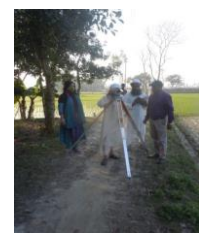
চিত্র-৪. সার্ভেয়ার কর্তৃক জরিপের মাধ্যমে কূপ খননের স্থানের সমূহের সমুদ্র সমতল হতে উচ্চতা নির্ধারণ
